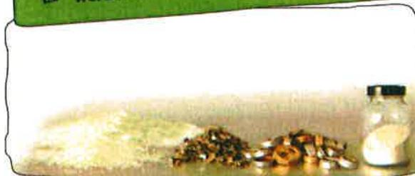
Nach dem Recycling bleiben folgende Stoffe übrig: 86,5 % Glas, 5 % Leuchtstoff, 7 % Metalle und 1,5 % Reststoffe (wie z.B. Gummi).
